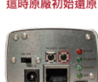
圖一、按下Reset鍵5秒，即可回復原廠預設。
